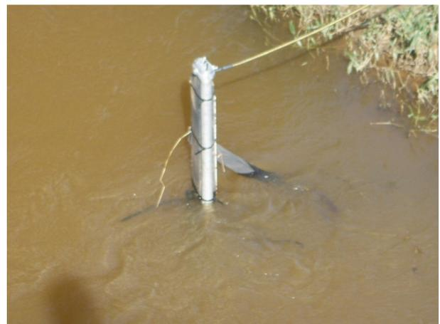
Figura 3.9 – Instalação de sensor de nível no rio Bocaina.
